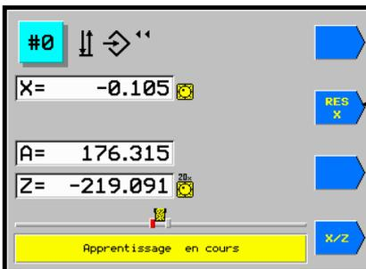
Le cycle d'apprentissage est terminé par une dépression du bouton **RES X** prolongée jusque le moment, quand la poupée de rectification est avancée dans la position WSP 2 mm en arrière et la poupée de rectification départira sur la voie de déplacement rapide en arrière.
