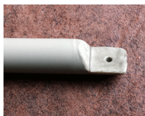
Obr. 5 Spojka vyrobená v přípravku z obr 4.
